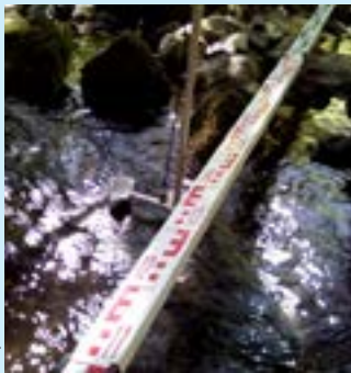
Mesure de débit avec un micromoulinet.
