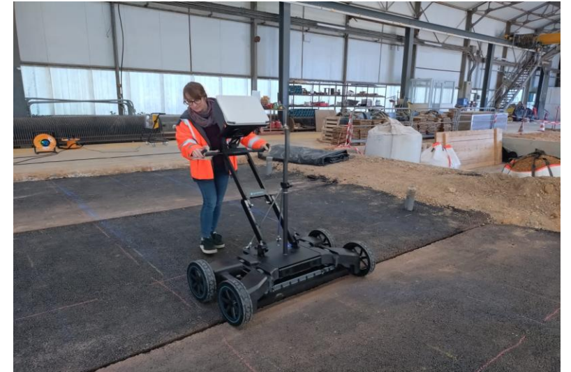
C. Herlent, Equipe Endsum. Auscultation horizontale par le radar 3D GS9000 GX2 de l'entreprise proceq
